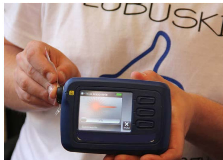
Spektrometr - urządzenie do szybkiego wykrywania dopalaczy
