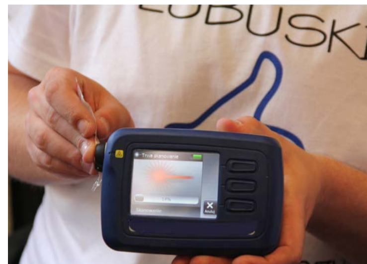
Spektrometr - urządzenie do szybkiego wykrywania dopalaczy
